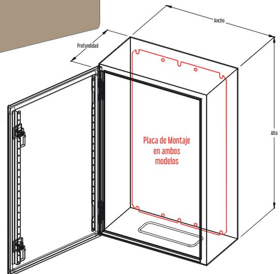
CAJAS / GABINETES (acero laminado en frío y recubrimiento con pintura poliéster endurecida) para montaje en pared, exteriores e interiores, cumple con NEMA 4 (IP65) con protección contra polvo y agua, cuatro agujeros para montaje trasero y llave. Contienen una Placa de acero galvanizado de 2mm de grosor al fondo para el montaje de los componentes que necesite.
